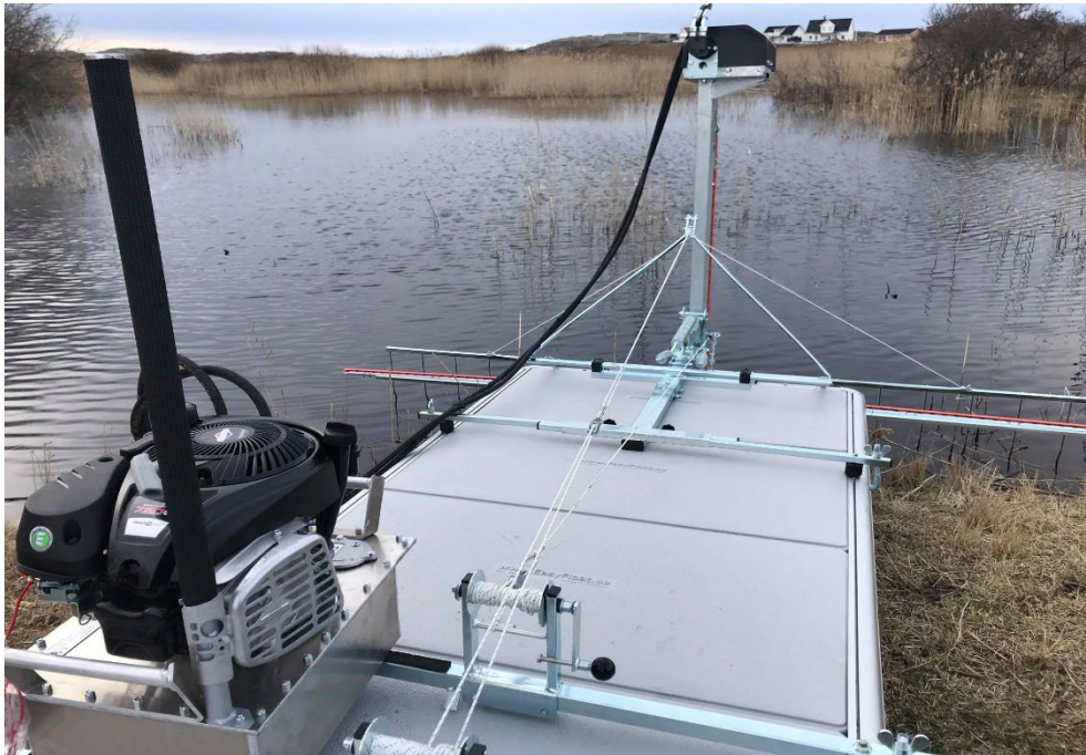
Fig. 7. Vassklippningsaggregat monterat på aluminiumflotte för att hålla dammpartierna i Rördammen öppna. Flotten drivs fram med hjälp av en elmotor monterad i aktern. Foto: Morgan Simonsson.
